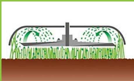
Le mulching est assuré par une lame spéciale et un système d'éjection.
